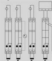
Простой преобразователь тока в испытательных цепях
