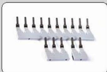
Соединительные рукава на перемычках вместе с винтами спаяны на шинах по группам по необходимому количеству полюсов. Требуется всего лишь вставить перемычки с необходимым количеством полюсов. Перемычки могут быть 2-х, 3-х и 10-ти полюсными. Извлечь перемычки можно с помощью плоскогубцев или других подобных инструментов. Этот способ подходит для клемм: RSTT6, RST6, TRTP4,...
