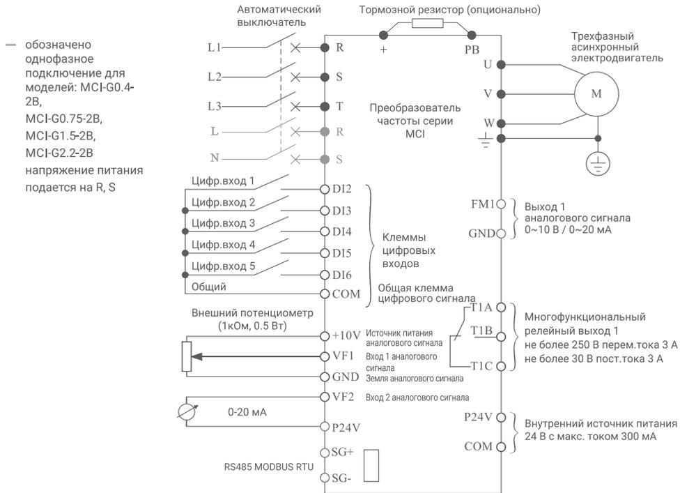
Стандартная конфигурация для преобразователей частоты серии MCI мощностью от 30 кВт и выше
